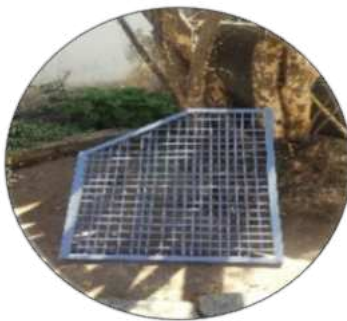
Dégrilleur : ce qui sépare les déchets plastiques de la boue
